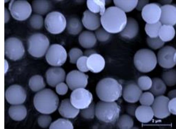
Microcápsula de Sílice Híbrida con cubierta porosa
